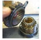
Die Feder auf die neue Spindel und dann das neue Freilaufrad aufsetzen.
